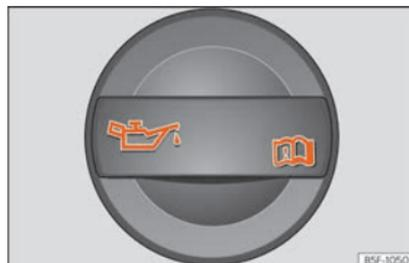
**Fig. 57** Vano motore: tappo del bocchettone di rifornimento dell'olio motore.
