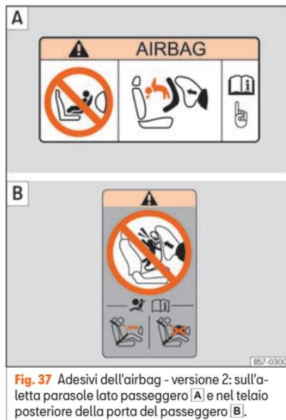
**Fig. 37** Adesivi dell'airbag - versione 2: sull'aletta parasole lato passeggero **A** e nel telaio posteriore della porta del passeggero **B**.
