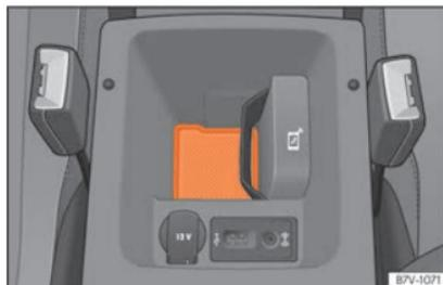
**Fig. 124** Bracciolo centrale anteriore: alloggiamento per il collegamento del telefono cellulare con l'antenna esterna del veicolo.
