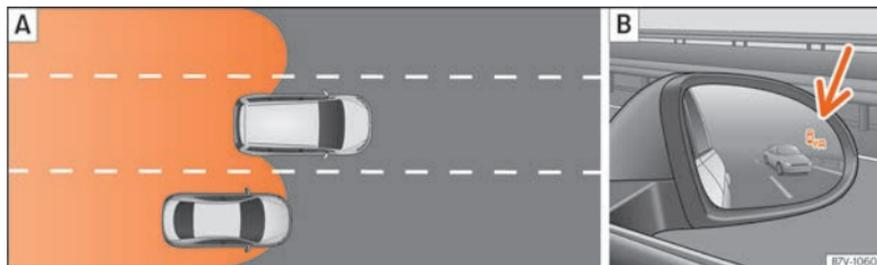
**Fig. 274** Rappresentazione schematica: **A** Situazione in un sorpasso e incorporamento successivo alla corsia destra. **B** Indicazione dell'assistente angolo cieco sullo specchietto retrovisore esterno destro.
