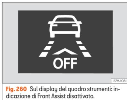
**Fig. 260** Sul display del quadro strumenti: indicazione di Front Assist disattivato.
