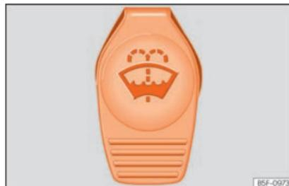
**Fig. 60** Nel vano motore: tappo del serbatoio del tergicristalli.
