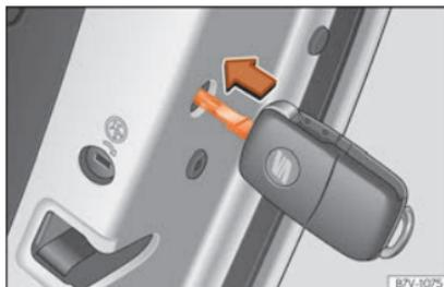
**Fig. 7** Blocco di emergenza del veicolo con la chiave.
