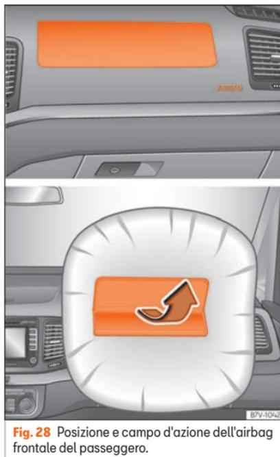
**Fig. 28** Posizione e campo d'azione dell'airbag frontale del passeggero.
