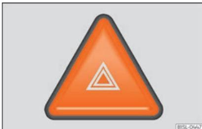
**Fig. 44** Plancia portastrumenti: interruttore lampeggio di emergenza.
