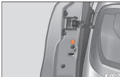
**Fig. 6** Nella parte anteriore della porta scorrevole: blocco di emergenza, nascosto da una guarnizione di gomma.
