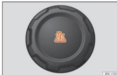
**Fig. 58** Vano motore: tappo del serbatoio di compensazione del liquido di raffreddamento.
