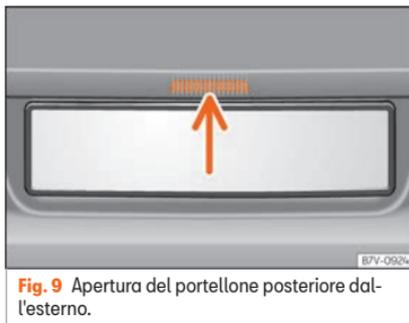
**Fig. 9** Apertura del portellone posteriore dall'esterno.
