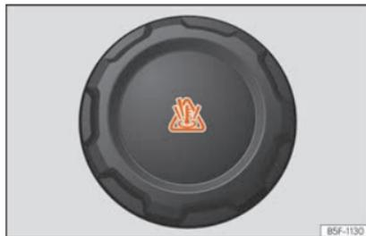
**Fig. 295** Nel vano motore: Tappo del serbatoio di compensazione del liquido di raffreddamento.
