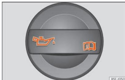
**Fig. 292** Nel vano motore: tappo del bocchettone di riempimento dell'olio motore.
