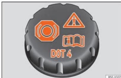
**Fig. 59** Vano motore: tappo del serbatoio del liquido dei freni.
