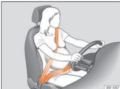
**Fig. 90** Posizione del nastro della cintura di sicurezza per donne in stato di gravidanza.
