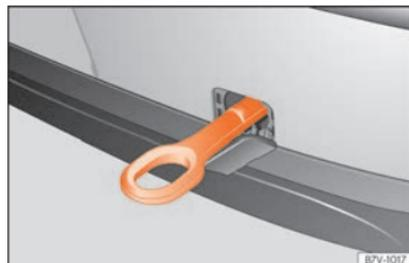
**Fig. 75** Nel paraurti posteriore, sul lato destro: Occhio di traino avvitato
