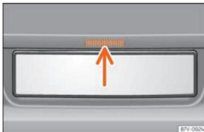
Fig. 141 Apertura del portellone posteriore dall'esterno.
