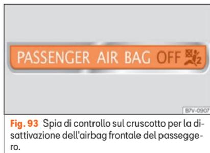
**Fig. 93** Spia di controllo sul cruscotto per la disattivazione dell'airbag frontale del passeggero.
