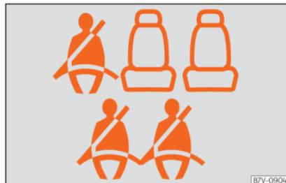
Fig. 85 Esempio di indicazione dello stato della cintura per i posti posteriori (in questo caso, veicolo a 7 posti) nel quadro strumenti: in alto, la seconda fila; in basso, la terza fila di sedili.
