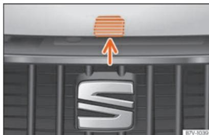
**Fig. 13** Leva sotto il cofano del vano motore.
