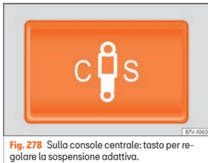
**Fig. 278** Sulla console centrale: tasto per regolare la sospensione adattiva.
