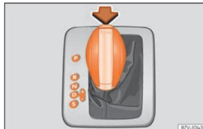
**Fig. 51** Cambio automatico: posizioni della leva selettiva.
