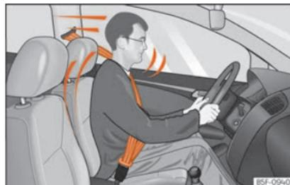
**Fig. 86** I conducenti che hanno la cintura di sicurezza correttamente allacciata non saranno proiettati fuori dal veicolo in caso di frenate repentine.
