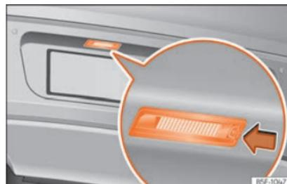
Fig. 117 Nel paraurti posteriore: illuminazione della targa.
