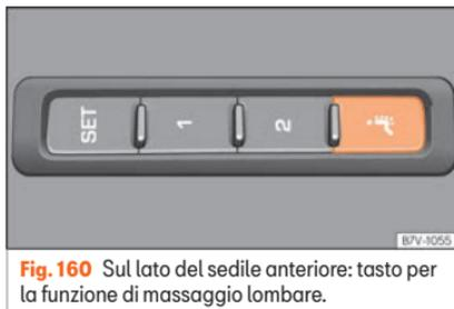
**Fig. 160** Sul lato del sedile anteriore: tasto per la funzione di massaggio lombare.
