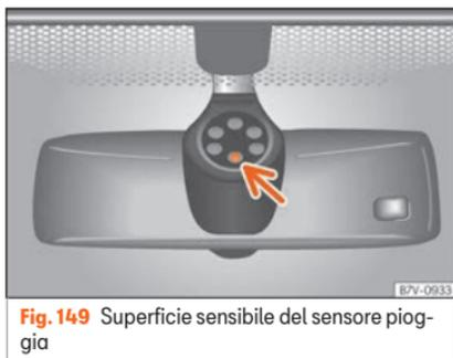
**Fig. 149** Superficie sensibile del sensore pioggia
