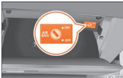
**Fig. 29** Nel cassetto portaoggetti, lato passeggero: interruttore a chiave per attivare e disattivare l'airbag frontale del passeggero.
