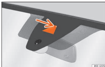
Fig. 173 Nel parabrezza: area del campo visivo della telecamera del dispositivo di assistenza per il mantenimento della corsia.
