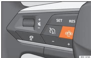
Fig. 74 Lato sinistro del volante multifunzione: chiave per i sistemi di assistenza alla guida (a seconda delle versioni).
