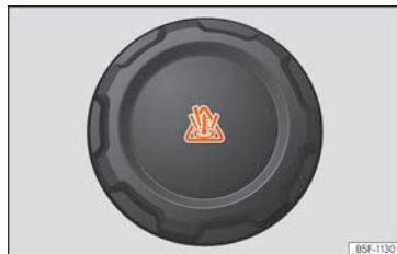
Fig. 236 Vano motore: tappo del serbatoio di compensazione del liquido di raffreddamento.
