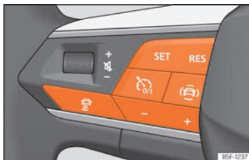
Fig. 182 Sul volante multifunzione: tasti di comando dell'ACC
