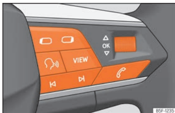
Fig. 72 Lato destro del volante multifunzione: tasti per l'utilizzo dei menu e delle indicazioni informative del quadro strumenti.
