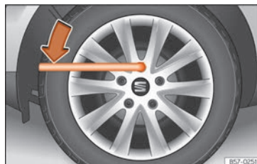
Fig. 44 Cambio di una ruota: allentare le viti della ruota.
