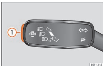
Fig. 73 Sulla leva degli indicatori di direzione e degli abbaglianti: chiave per i sistemi di assistenza alla guida (a seconda delle versioni).
