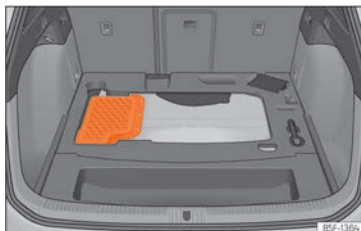
Fig. 239 Veicoli ibridi (PHEV): alloggiamento della batteria all'interno del bagagliaio
