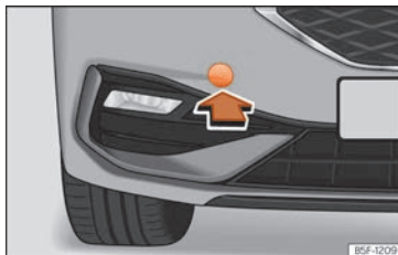
Fig. 52 Sul lato destro del paraurti anteriore: estrarre il coperchio.
