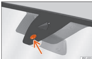
Fig. 110 Superficie sensibile del sensore pioggia.
