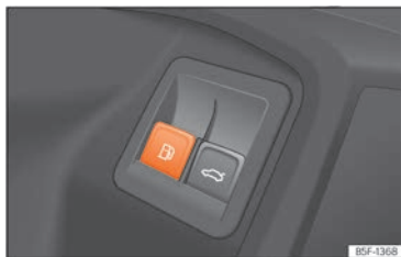
Fig. 222 Porta del conducente: sblocco dello sportellino del serbatoio.
