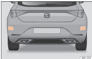
Fig. 174 Vista posteriore del veicolo: zone dei sensori radar.
