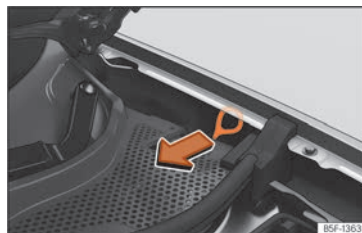
Fig. 218 Tra l'ala sinistra e la cerniera del cofano motore.: Maniglia per lo sblocco di emergenza del connettore di ricarica.
