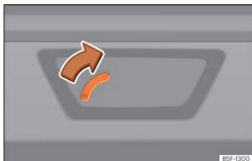
Fig. 99 Particolare del bagagliaio: sblocco di emergenza (Leon Sportstourer).
