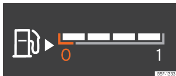
Fig. 69 Quadro strumenti digitale: indicatore del livello di carburante situato in posizioni diverse a seconda della visualizzazione.
