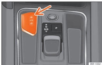
Fig. 83 Console centrale: alloggiamento della chiave di accensione.
