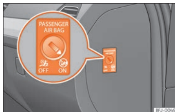
Fig. 20 Interruttore a chiave per l'attivazione e la disattivazione dell'airbag del passeggero.
