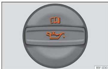
Fig. 233 Vano motore: tappo del bocchettone di rifornimento dell'olio motore.
