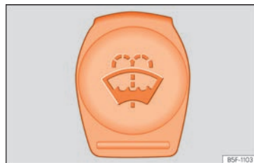
Fig. 238 Nel vano motore: tappo blu sul serbatoio del lavavetri.
