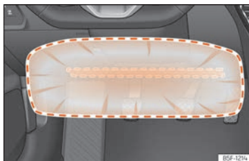
Fig. 23 Sul lato conducente: raggio d'azione dell'airbag per le ginocchia.
