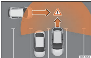
Fig. 195 Rappresentazione schematica dell'assistente di uscita dal parcheggio: zona vigilata attorno al veicolo che sta uscendo dal parcheggio.
