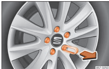
Fig. 42 Ruota: viti della ruota con tappi.
