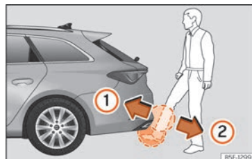
Fig. 97 Portellone del bagagliaio con apertura controllata da sensore (Easy Open).
