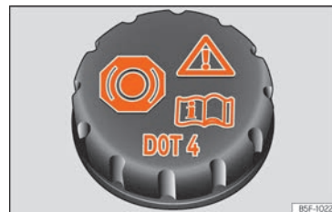
Fig. 237 Vano motore: tappo del serbatoio del liquido dei freni.
