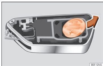
Fig. 86 Chiave del veicolo: estrarre la batteria.
